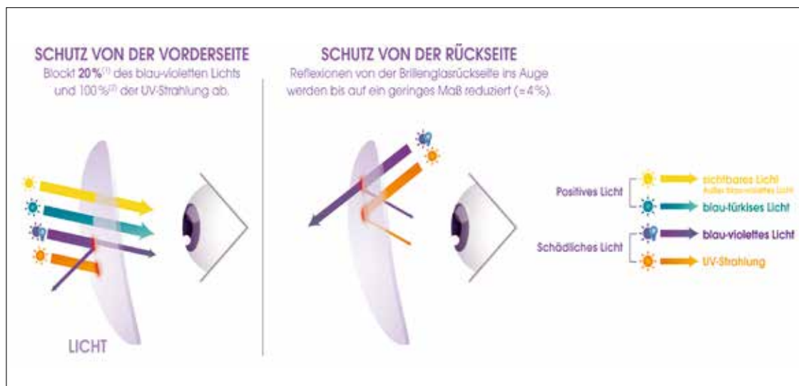
Abb. 5: Crizal Previncia mit selektiver Filtertechnologie auf Vorder- und Rückseite zum Schutz des Auges vor schädlichen UV-Strahlen sowie blau-violetterm Licht. Gleichzeitig wird das sich positiv auf den Biorhythmus auswirkende blau-türkise Licht durchgelassen.
